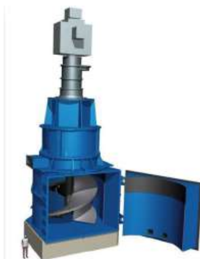
Figura 2-20: Torre de remolienda
