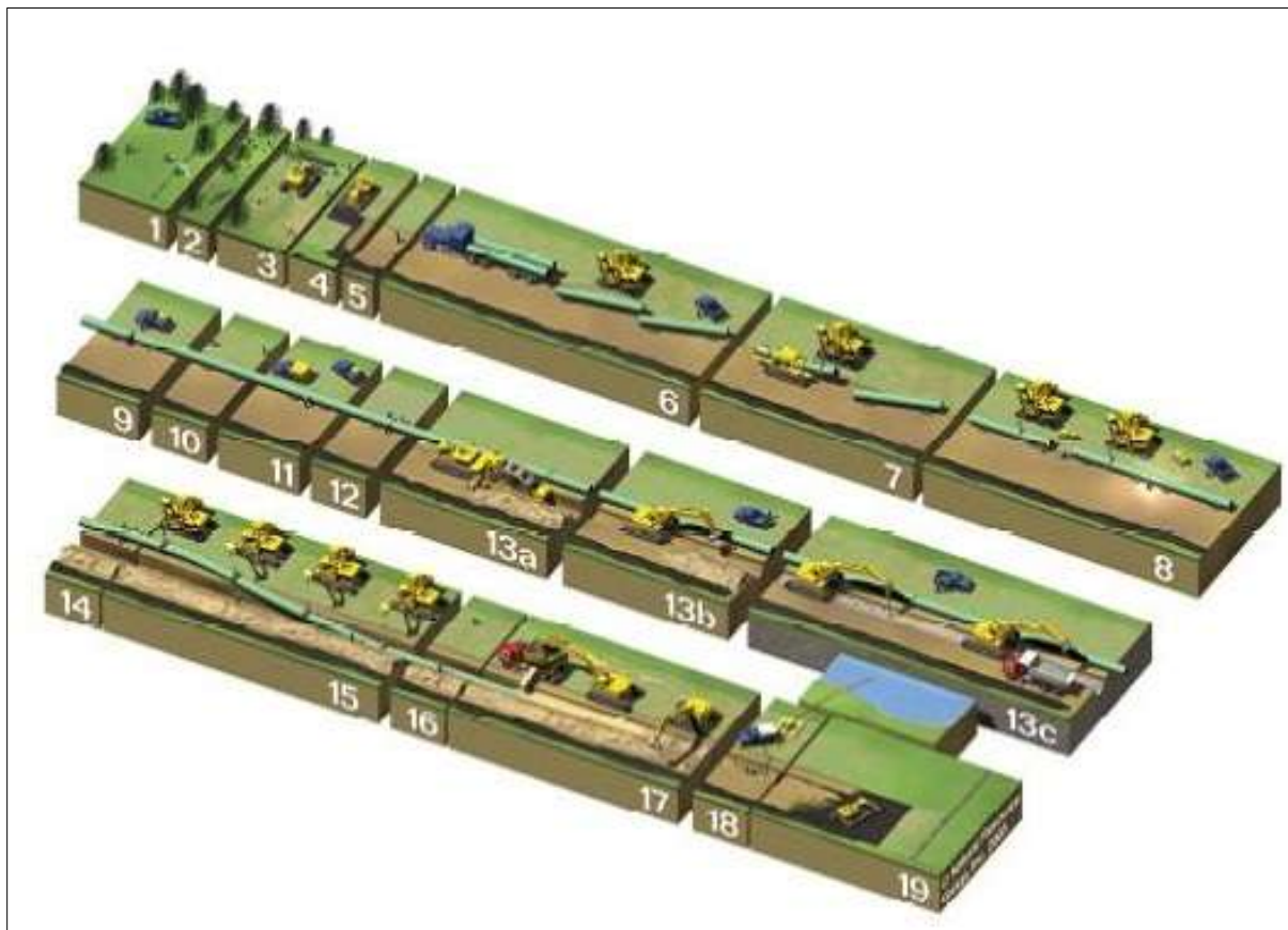
Figura 3-3 Secuencia típica de construcción del MD
